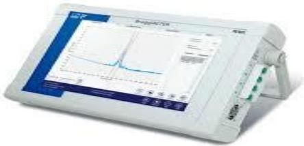
Durante la adquisición de datos, el interrogador mide la longitud de onda asociada a la luz reflejada por los sensores ópticos y la convierte a unidades técnicas. A continuación, transmite las lecturas a través de Ethernet o FireWire para archivarlas, analizarlas o exportarlas, con ayuda de una interfaz de software. Con una configuración adecuada de módulos QuantumX, el interrogador puede integrarse con distintos protocolos de comunicaciones, como PROFIBUS o CANbus.
